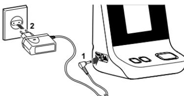
Para desconectar la toma de corriente, desenchufe primero el adaptador de CA de la toma de corriente y retire la clavija del adaptador de CA de la unidad.
