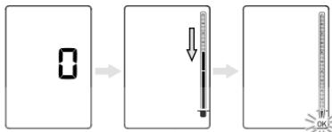
3. Compruebe la pantalla donde se muestra "0" y realice una comprobación de la precisión de la presión.
