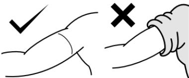
Appicare il bracciale sul braccio nudo o su indumenti sottili. Gli indumenti spessi o le maniche rimboccate possono determinare risultati imprecisi nella misurazione della pressione arteriosa.
