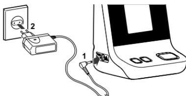
**Zum Trennen vom Netzstrom zuerst das Netzteil aus der Steckdose und dann den Netzteilstecker aus dem Messgerät ziehen.**
