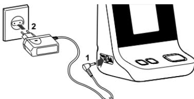
Pour débrancher l'adaptateur secteur, le déconnecter d'abord de la prise électrique, puis retirer la fiche de l'adaptateur secteur de l'unité principale.
