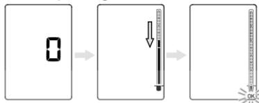
3. Prüfen Sie die „0“-Anzeige und führen Sie die Druckgenauigkeitsprüfung durch.
